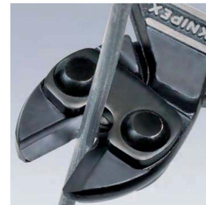
71 31/32/41 200: Durch die gelenknahe Schneiden-Aussparung werden dickere Drähte in einer günstigen Schneidposition gehalten (optimale Hebelverhältnisse). Das bei Bolzenschneidern übliche Nachsetzen entfällt.
