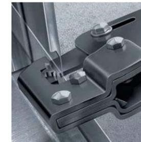
Das Stempelwerkzeug wird durch die Profilbleche gedrückt
