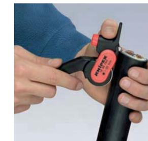
Ansetzen des Werkzeugs für Längsschnitt
