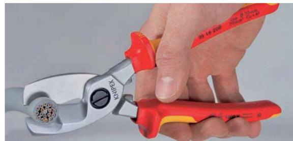
**Vorschnitt:** durch Einsatz der vorderen Schneide zum Schneiden des Isoliermantels bleibt selbst bei größeren Kabeldurchmessern eine ergonomische Griffweite erhalten.
