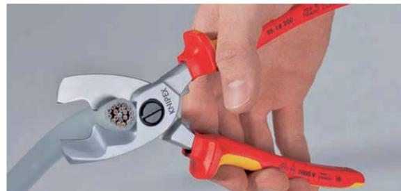
**Nachschnitt:** Bei größerem Kraftbedarf (Schneiden der Leiter) ist ein Nachsetzen in das Schneidenprofil am Gelenk möglich. Vorschnitt vorne – Nachschnitt hinten
