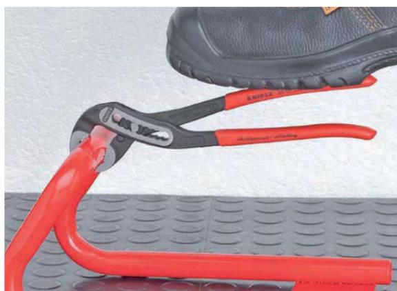
Selbstklemmend an Rohren und Muttern: kein Abrutschen am Werkstück; die gesamte Betätigungskraft kann zum Drehen der Werkstücke eingesetzt werden; festes Zusammenpressen der Zangenschenkel ist nicht erforderlich, dadurch weniger Kraftaufwand
