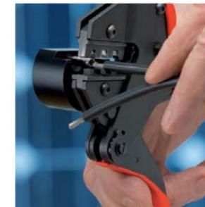
Da die Systeme untereinander nicht kompatibel sind, ist für jeden Steckertyp ein anderes Werkzeug bzw. ein passender Crimpeinsatz erforderlich. Die Möglichkeit, mit Positionierhilfen schnelles, einfaches und präzises Arbeiten zu unterstützen, rundet das Programm ab.
