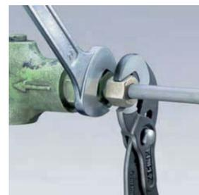
Schraubzange als zweiter „Schlüssel“ bei Konterverschraubungen
