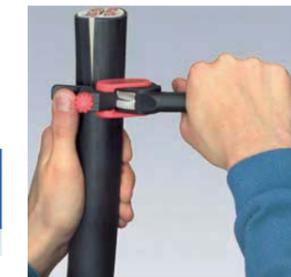
Drehen des Werkzeugs für Umfangsschnitt
