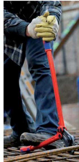
Angeschmiedeter Anschlag mit Dämpfungs-Einsatz: dämpft den Schnittschlag komfortabel ab
