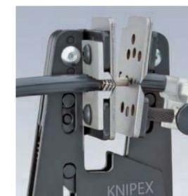
Automatisches Abziehen der Isolation
