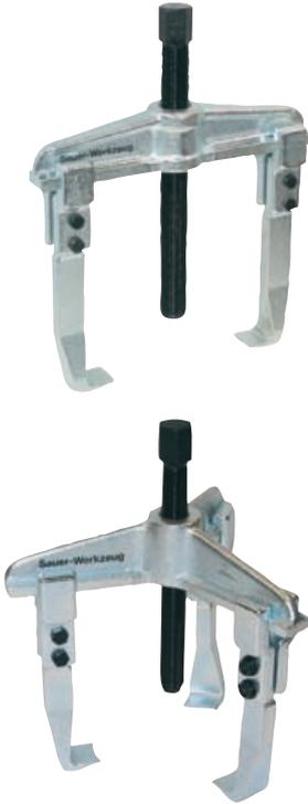
Geschmiedete Abzieher, CV-Stahl mit extra gehärteter Spindel und Kugel. Durch umsteckbare Haken als Außen- und Innenabzieher verwendbar.
