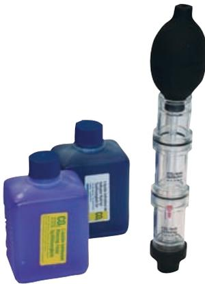
Für wassergekühlte Verbrennungsmotoren. Die regenerierende Testflüssigkeit dieses funktionssicheren Gerätes verfärbt sich automatisch bei Undichtigkeit und gewährleistet exakte Prüfergebnisse. Das Gerät wird mit je 250 cm<sup>3</sup> Test- und Reinigungslösung in stabiler Holzkassette geliefert.
