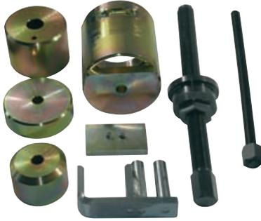
Zur hydraulischen Demontage/Montage der sehr festsitzenden großen Silentlager an der Hinterachse am Fahrzeug. Die Längslenker müssen dafür nicht ausgebaut werden. Zum Antrieb wird unser 12t Hohlkolben-Zylinder aus dem Hydraulik-Set Mod. S benötigt.
