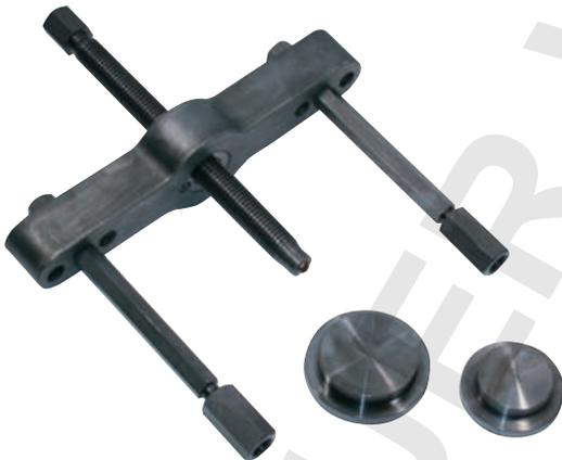
Mit den Gewindeadaptern wird die Gegenstütze an den Radbolzen befestigt. Die auf die Achstypen abgestimmten Druckpilze erlauben dann ein beschädigungsfreies und zentrisches Abziehen der Nabe.
