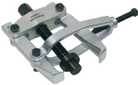
Abzieher mit Spannbügel und Druckpils zum Abziehen des Radlager-Innenringes von der demontierten Vorderradnabe.
