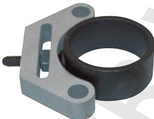
Zum Einstellen des Sturzes an der Vorderachse. Der Schlüssel greift mit dem Justiererring von oben in den Federdom-Ausschnitt. Das Verstellstück wird an den Haltebolzen (Muttern lösen) des Federbeins montiert. Der Sturz wird jetzt über die Verstellmutter des Schlüssels eingestellt.
