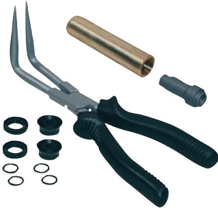
Zum Instandsetzen von Girling-Bremssätteln mit integrierter Feststellbremse (Handbremse). Das Werkzeug ermöglicht die Demontage der Handbremsmechanik im Bremssattel. Ohne das Werkzeug muss der Bremssattel häufig erneuert werden, da der festgerostete Handbremshebel nicht fachgerecht instandgesetzt werden kann.
