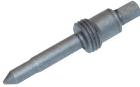
Zum Blockieren der Verteiler Einspritzpumpe in Stellung Förderbeginn bei der Montage/Demontage.
