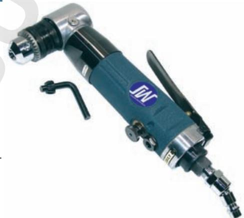
Leistungsstarke Winkelbohrmaschine für Arbeiten an schwer zugänglichen Stellen. Mit Umschalter für Rechts- & Linkslauf, profiliertes Griffstück zur komfortablen Bedienung. Kraftvoller Durchzug für zuverlässigen Einsatz z.B. beim Ausbohren abgerissener Stehbolzen.
