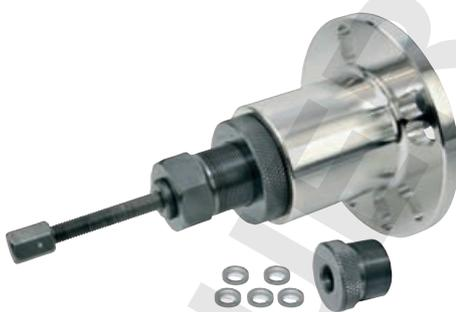
Zum Ausdrücken der Gelenkwelle und in Verbindung mit dem Flughammer zum Ausziehen der Radnabe. Beide Flansche können auch mit dem 12t Hydraulik-Hohlkolbenzylinder\* eingesetzt werden (\*12t Adapter und 12t Spindel müssen vorhanden sein).
