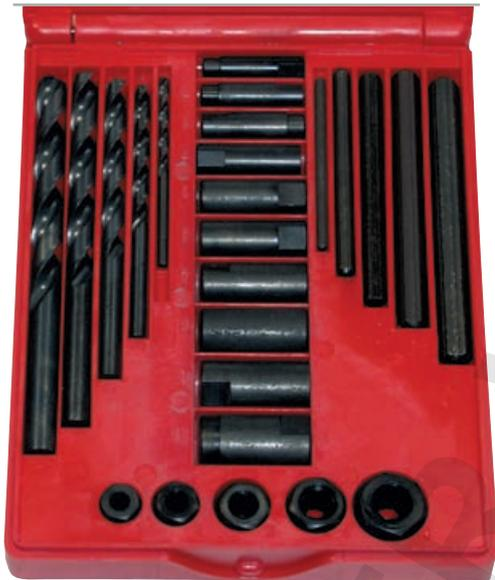
Spezial-Ausdreher-Satz aus Sonderstahl zum Entfernen abgerissener Schrauben und Bolzen von 5 - 16 mm bzw. 3/16" - 5/8". Einsetzbar bis zu 25 mm Tiefe. Kein Erweitern der Bohrung und keine Beschädigung des Gewindes.
