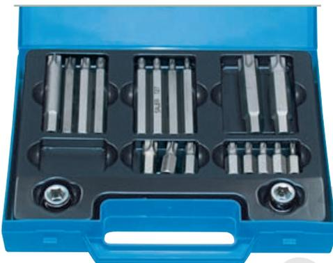
Die Sätze bestehen aus gehärteten Bits in jeweils 2 Längen, 30 und 75 mm (Länge mit Adapter 1/2" + 20mm, 3/8" Adapter +15mm), mit SW 10 6kt. Antrieb und zwei Aufnahme-Adaptoren mit 3/8" und 1/2" □-Antrieb.
