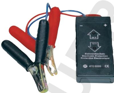
Dieses Gerät wurde zum Schutz von Elektronik-Bauteilen im Kraftfahrzeug bei auftretenden Spannungsspitzen, z.B. bei Schweißarbeiten, beim Laden der Batterie, oder wenn Starthilfe gegeben wird, entwickelt. Somit können elektronische Bauteile im Fahrzeug geschützt werden, ohne die Fahrzeugbatterie abklemmen zu müssen. Das Gerät wird an der Batterie angeschlossen und verfügt über eine automatische Spannungskennung, so daß der Einsatz bei 12 V und 24 V möglich ist.
